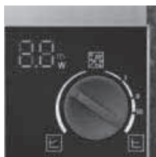
LED-Anzeige zur Sollwerteneinstellung und Leistungsanzeige.
